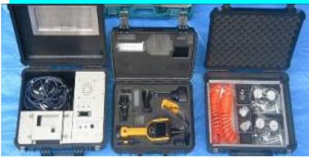
先端チューブにCCDカメラが装備されマイク、スピーカー、センサーなどを取り付けることができ、遠隔操作が可能でチューブから生存者に空気を送ることやガス、温度測定などが可能です。活動には瓦れき等にカメラを挿入する隊員とモニターを確認する隊員が最低2名必要となります。
