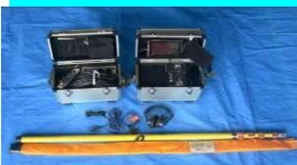
先端ケーブルに照明、CCDカメラの設置が可能で、先端を瓦れきの隙間に差込み、内部状況をモニターに写し出すことができ、また音声も同時に拾うことができるもので、下敷きになった生存者の発見に役立ちます。隊員1人で操作が可能です。
