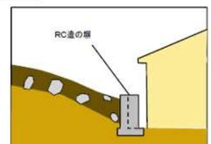
想定される土石流の高さや衝撃力に応じて定められた仕様を満たす鉄筋コンクリート造の外壁等を設ける
