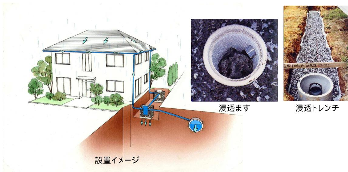
図 7-16 雨水浸透施設の設置イメージ
