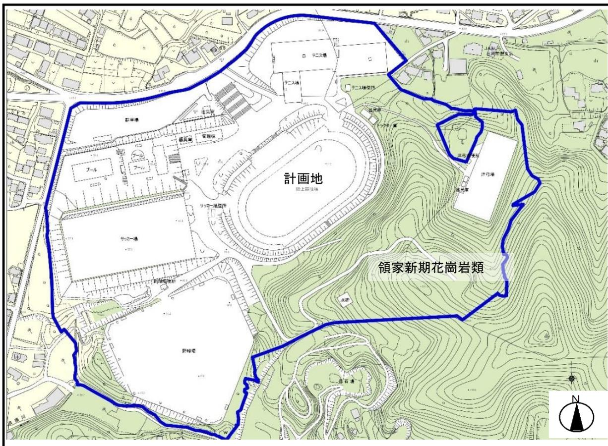
計画地周辺のボーリングデータより、地質の状況を考察します。計画地を囲むように位置する3つのボーリングデータ（A、B、C）は、どれも基本的にシルト混じりの砂層の下に花崗岩が風化してできたマサ土の層や花崗岩の層となっており、マサ土、花崗岩の層においてはN値50以上となる非常に固い岩盤の層が形成されています。計画地においても、広域的な地質状況もふまえて既存のデータと同等の地質状況であると推測されますが、施設の建設時における実際のボーリング結果に応じて詳細な基礎の設計に反映させる必要があります。
