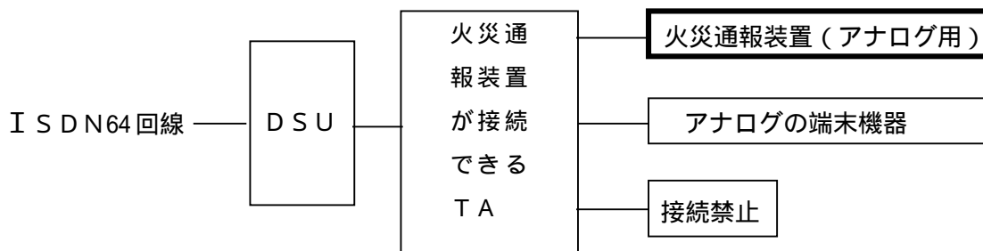
図 5 c T A に D S U が内蔵されていない場合又は T A に組み込まれた D S U を使用せず、別に設置した D S U を使用する場合の各接続端子の接続例
