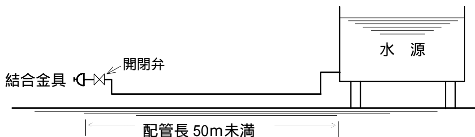
図 1 a 地上式の水源地を有する消防用水
