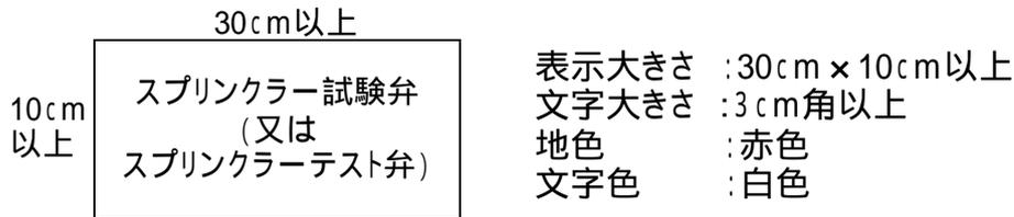
イ 配管室、専用室等内に末端試験弁を設ける場合は、当該扉又は点検口前面等に前記アの表示を設けること。
