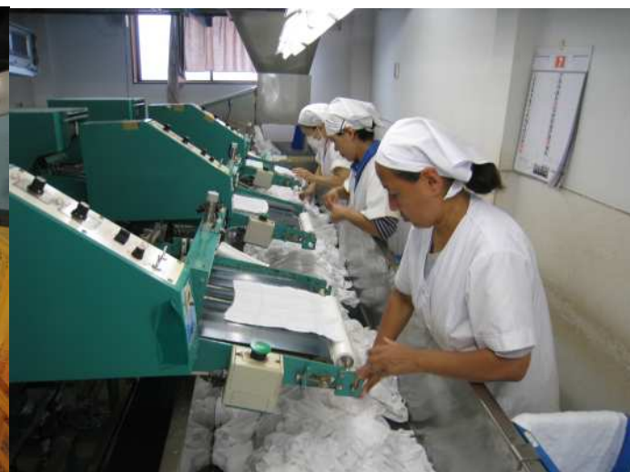
【洗浄されたおしぼりを検品し機械に流します】
