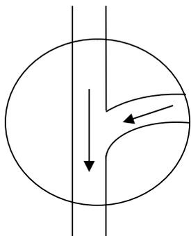
注) 既設管渠の流れる方向に対し、接続管渠の流れる方向が逆方向とならないこと。
