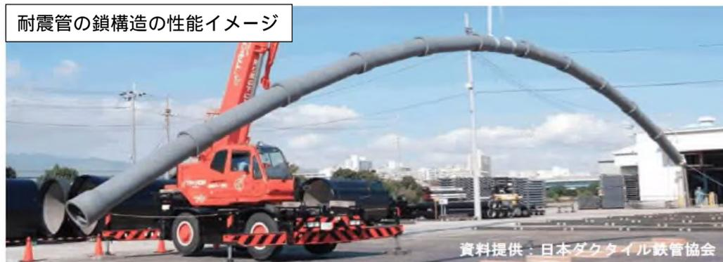
耐震管とは、地震時に起きる地盤のひずみを継手が伸縮・屈曲する鎖構造管路により吸収し、管本体の損傷を防ぐものです。
