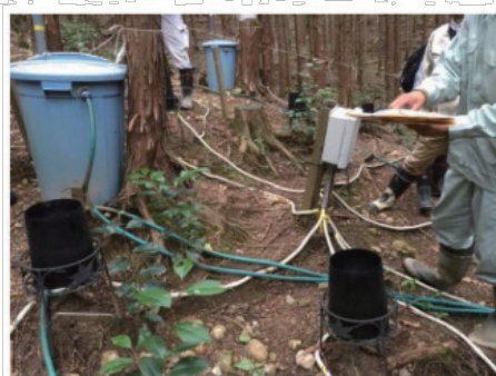
林内雨量及び樹幹流下量の測定
