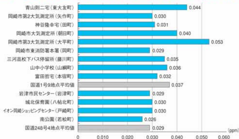
図2-7 国道1号9地点及び国道248号4地点二酸化窒素簡易測定結果(ppm)
