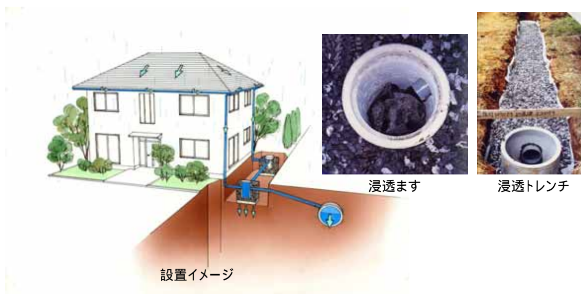
図 5-6 雨水浸透施設の設置イメージ
