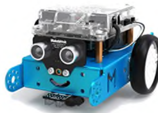
各種センサー付き自走式ロボ
