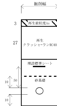
仮復旧 歩道小型車乗入
