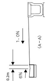
現況が歩道タイプの側溝である場合、側溝布設替えが必要になります。
