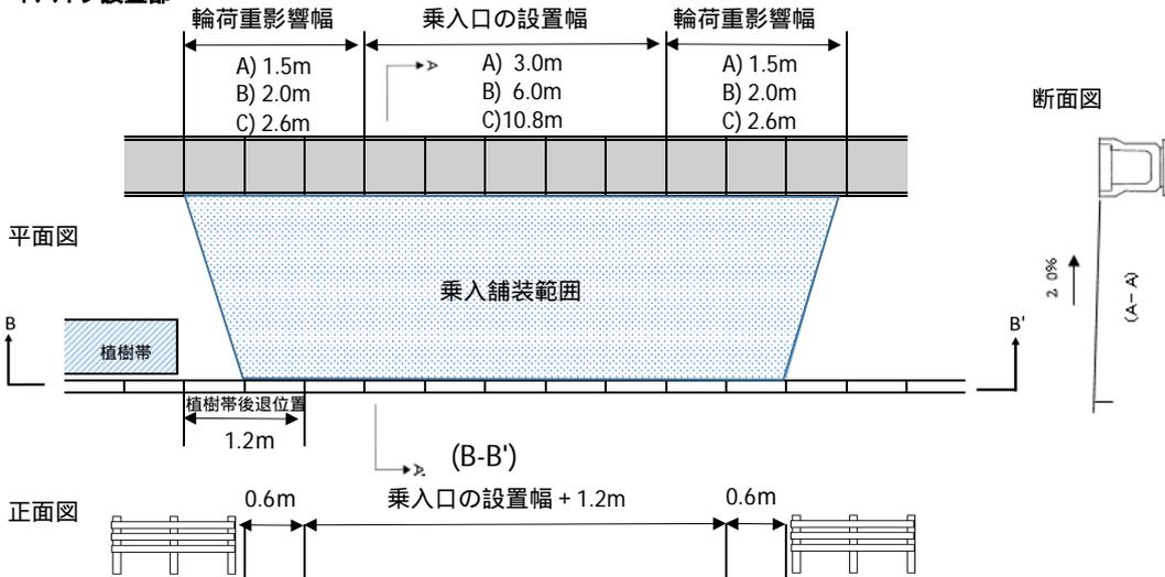
現況が歩道タイプの側溝である場合、側溝布設替えが必要になります。
