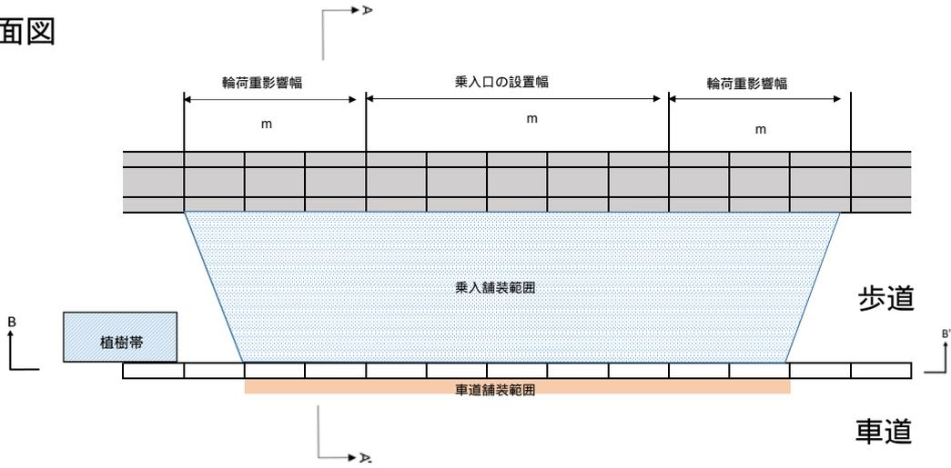
植樹帯、歩者分離ブロックの撤去に伴い舗装に影響が出る場合は掘削線から30cmのラインで舗装復旧をしてください。
