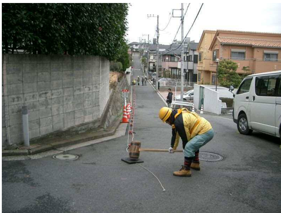
図参 6. 4-⑤ 表面波探査試験の実施風景
