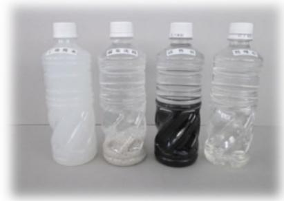
工場廃水→凝集沈殿→活性炭→処理水
