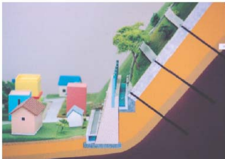
がけ崩れを防ぐ工事の一例
