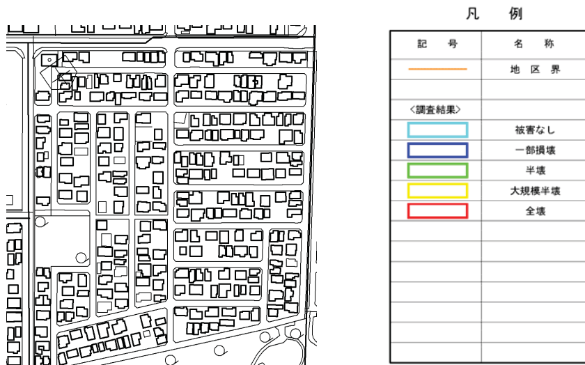
図-14 住宅被害認定による建物の被害程度マップ
