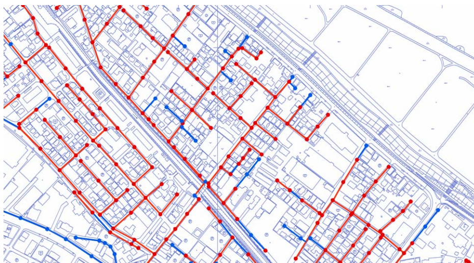
図3-10 下水道被災マップの作成例 7)
