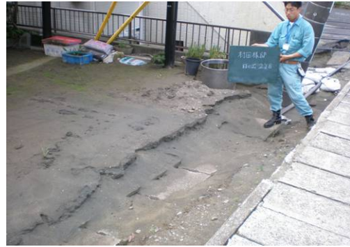
写真3-2 宅地地盤の液状化に伴う大規模な噴砂状況 6)
