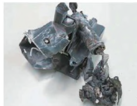
掃除機のバッテリー (令和4年11月 市内のごみ処理施設で発火)
