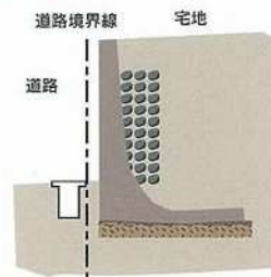
(例) コンクリート造擁壁
