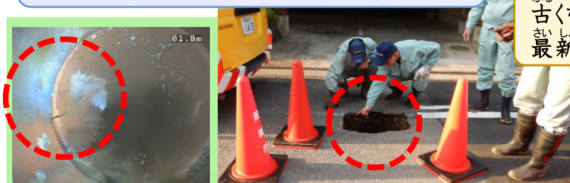
▲老朽化(ひび割れ、隙間)した下水道管による道路陥没事故
