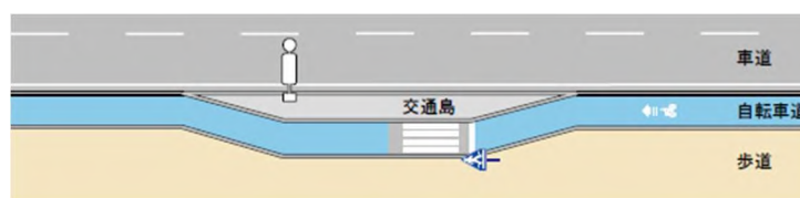
図4 車道と自転車道との間に交通島のバス停留所を設ける例（バス交通が多く道路空間に余裕がある路線）
