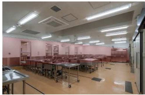
↑ 汚染作業区域（下処理スペース）を壁で区分け
