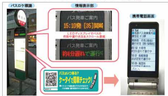
図2-10 バスロケーションシステムの整備
