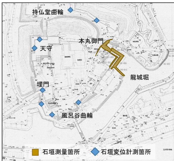
図4 岡崎城跡石垣計測箇所
