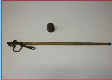
竿につけた取っ手のひもを支点とし、フックに計量するものを吊り下げ、反対側に下げた分銅を移動させ水平に保つ位置の目盛で量ります。
