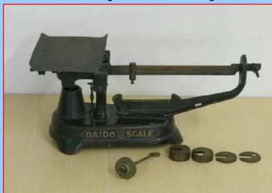
このように分銅を使う方法から、パネを利用して針で重さを表示する方法に変わっていきました。現在は電子式でデジタル表示するタイプが主流です。
