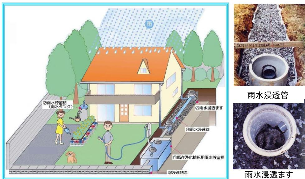
図 7-14 雨水浸透施設の設置イメージ
