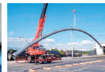
▲地震に強い水道管 (写真提供：日本ダクタイル鉄管協会)
