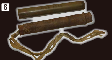
▲M69焼夷弾の筒 日本を空襲するために開発された長さ約50センチの小型の焼夷弾。着地した衝撃で発火し、なかに詰められた油脂が燃え広がって火災を起こしました。
